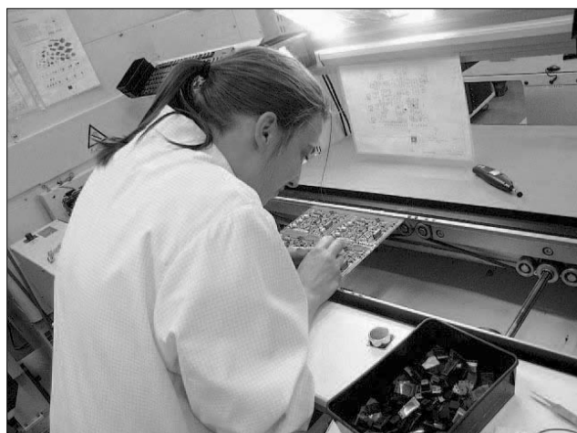
Les composants qui ne sont pas produits en série doivent être assemblés à la main. C'est aussi le cas des très gros composants.
